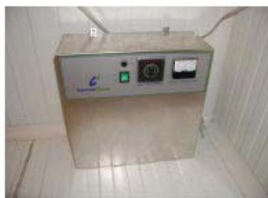
**Fig. n°3.- Generador de ozono en el interior de la cámara**
