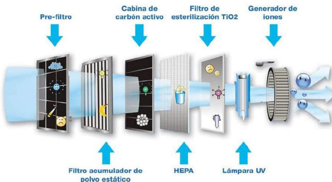
La filtración del aire mediante los tres primeros elementos que conforman nuestros sistemas nos permiten retener partículas de polvo que portan una gran cantidad de alérgenos, microorganismos y ácaros. Posteriormente, y tras una filtración de alta eficiencia (HEPA) se produce la desinfección del aire por medio de un catalizador de Dióxido de Titanio y la acción de los rayos Ultra Violeta. Finalmente el aire vuelve al ambiente ionizado.
