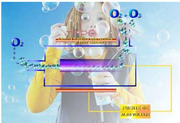
Debido a la inestabilidad del compuesto, el ozono debe ser producido en el sitio de aplicación mediante unos generadores. El funcionamiento de estos aparatos es sencillo: pasan un flujo de oxígeno a través de dos electrodos. De esta manera, al aplicar un voltaje
