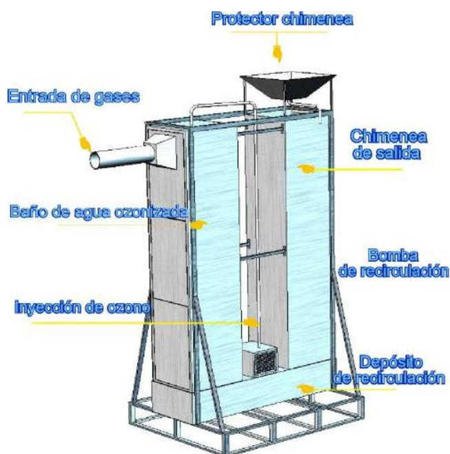
Para ello se extrae el aire de las instalaciones mediante turbinas o extractores adecuados; los gases, dirigidos por tuberías, ingresan en la torre de lavado a través de una tolva de entrada.
